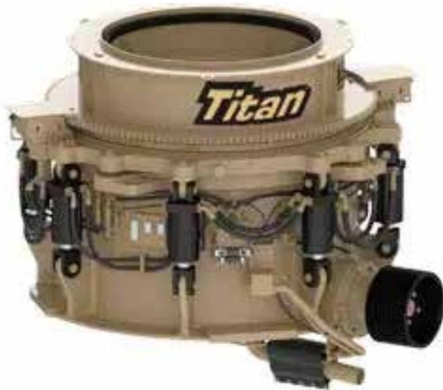
*La chancadora cónica Titan de Telsmith es un equipo robusto y eficiente, ideal para trituración secundaria, terciaria o cuaternaria en minería y construcción. Ofrece alta capacidad, bajo consumo energético, fácil mantenimiento y seteo rápido, garantizando rendimiento y confiabilidad en aplicaciones exigentes.*
